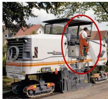
Fig. 06 - Protezione del posto di guida scarificatrice
